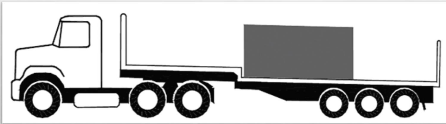
پایین بودن سطح کفی تریلر به دلیل ایجاد ماکزیمم پایداری
